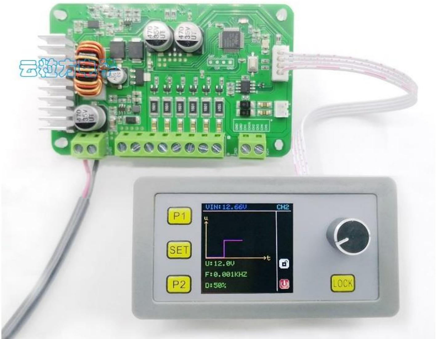
**版本说明：**此模块分为两个版本，信号发生器和带有 MODBUS 功能的版本，区别在于带有 MODBUS 版本的电源具有 RS485 通讯接口，可以用上位机软件进行设置或者采集数据，也可以与电脑、PLC、DCS、智能仪表等设备进行通讯！除此之外，其他功能一样！
