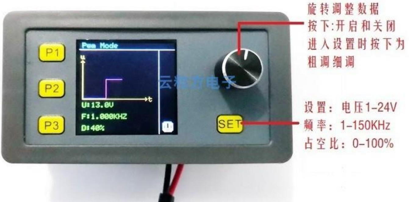
**脉冲模式 PULSE:** 按 1 次 P2 进入，按 SET 键可依次切换设置电压、时间 T0\T1\T2、脉冲数量，旋转编码器可调整数据（短按可切换粗调、细调），调整过程中信号是实时输出的，调整数据完成按 SET 键退出，退出 SET 状态时短按编码器可开始或者关闭输出。
