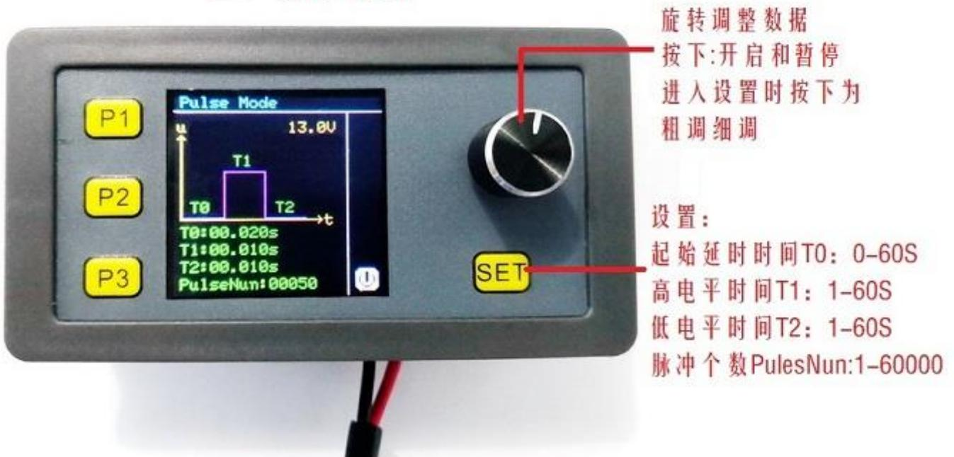
**电压电流信号源模式：**按 1 次 P3 进入，按 SET 键可依次切换设置电压、电流，进入即开始输出信号，旋转编码器可调整数据（短按可切换粗调、细调），调整过程中信号是实时输出的，调整数据完成按 SET 键退出。
