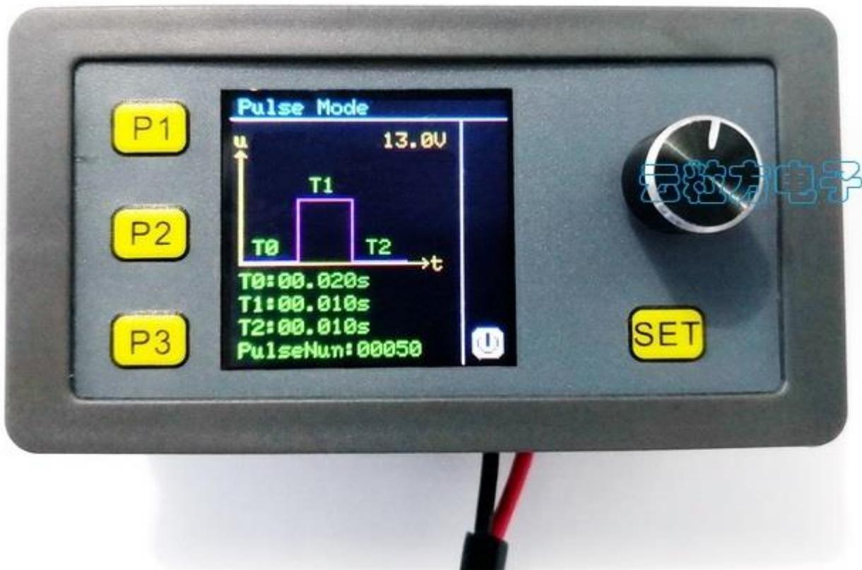
**版本说明：**此模块分为两个版本，信号发生器和带有 MODBUS 功能的版本，区别在于带有 MODBUS 版本的电源具有 RS485 通讯接口，可以用上位机软件进行设置或者采集数据，也可以与电脑、PLC、DCS、智能仪表等设备进行通讯！除此之外，其他功能一样！
